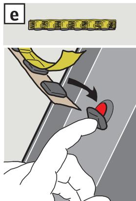
**ESPAÑOL:** Desmonte los perfiles indicados, provisionalmente **a**. Recuerde la posición de los perfiles para colocarlos con facilidad más adelante. Quite los tornillos de los perfiles exteriores excepto los superiores **b**. Si en la parte superior hubiera una marca, en vez de un tornillo, haga un taladro **c**. **No** quite el perfil lateral del marco **d**. Selle **todos** los orificios de los tornillos **e**.
